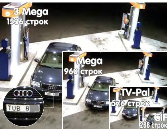
Оригинальное изображение с камеры MOBOTIX: разница между стандартом CIF и HiRes MOBOTIX
